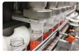
**COUNTLAB® Street Fighter™** contadora electrónica de pastillas y cápsulas que sobrepasa las especificaciones cGMP (buenas prácticas de manufactura actualizadas) e incrementa la eficiencia en la producción. Estas pueden adaptarse a un amplio rango de tamaño y forma de contenedores. Actualmente, hay 3 modelos disponibles, la SF-50, SF-100 y SF-200, para ajustarse a diferentes requerimientos de velocidad.
